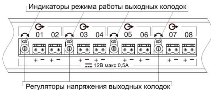
Рисунок 2 - описание коммутационных элементов преобразователя напряжения PN-V.8
